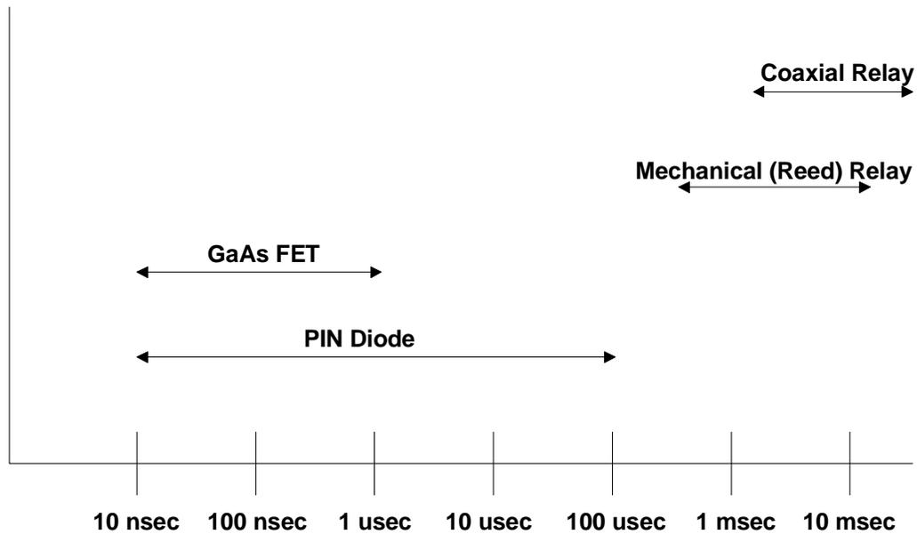
**Figure 3-5 : Switching Speed**
