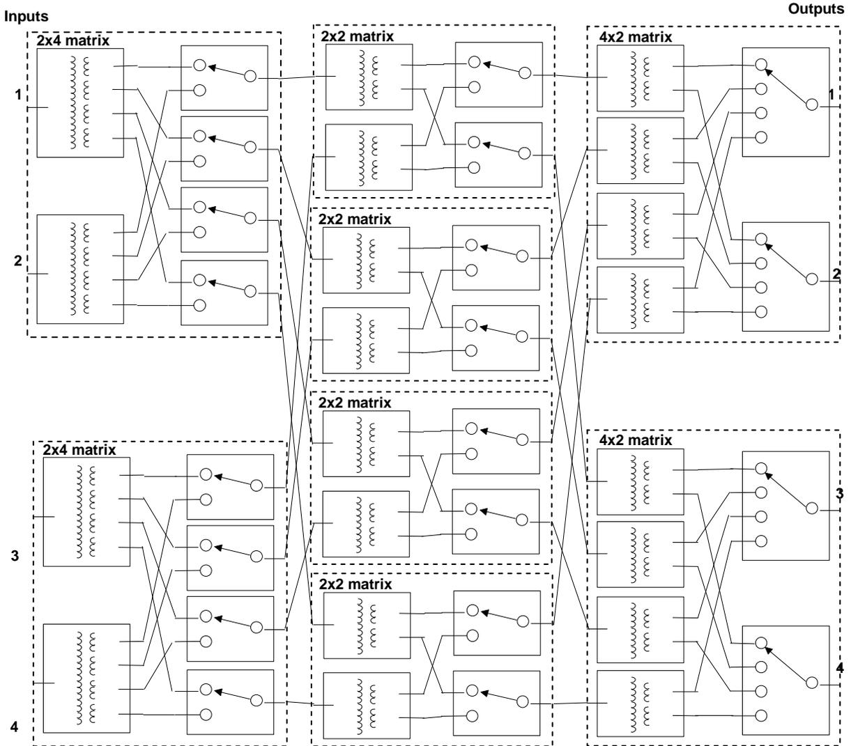
**Figure 2-4 : 4x4 3-Level Non Blocking Matrix**
